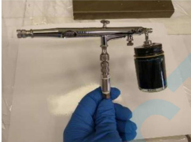
Abbildung 4 – für die Prüfung verwendete Airbrush-Pistole AFC-101A mit wässriger Kurkuma/Methylenblau-Dispersion.
